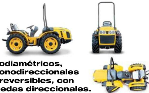
**Isodiamétricos, monodireccionales o reversibles, con ruedas direccionales.**
